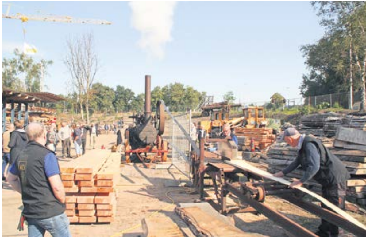
De zogenaamde Schulpzaag werd aangedreven door een heuse stoommachine.
